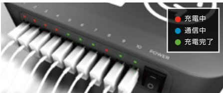
充電中/通信中のステータスLED搭載
