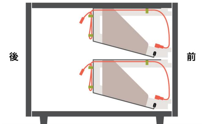
1で確認した配線クリップを通すようにケーブルを結束します。
