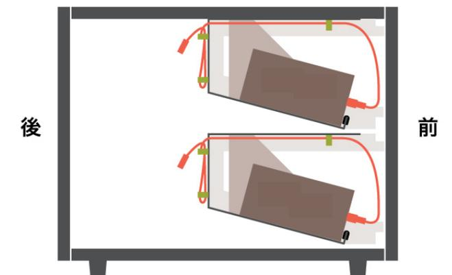
実際にスマートフォンを収納して、充電ケーブルの長さを調整します。
