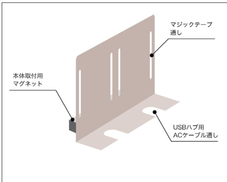
USBハブ取付ホルダーは、マジックテープでUSBハブ本体を固定し、取付プレート背面にあるSecure2への取付用マグネットを使ってSecure2に取付けます。
